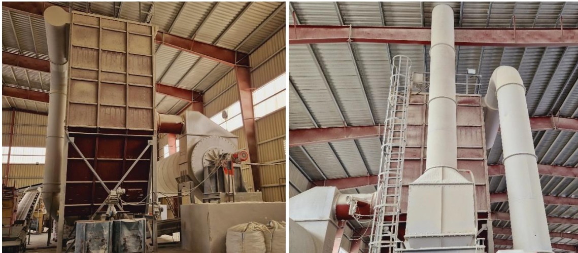
სურათი 2.3.2.6. საშრობი დოლის აირგამწმენდი სისტემა
