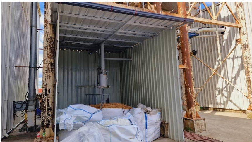
სურათი 2.3.6.2. სამარაგო სილოსების ქვეშ მოწყობილი მექანიკურად-ხელით შეფუთვის ადგილი
