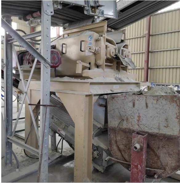
სურათი 2.3.2.2. ქვის სეპარატორი და შემრევი აგრეგატები
