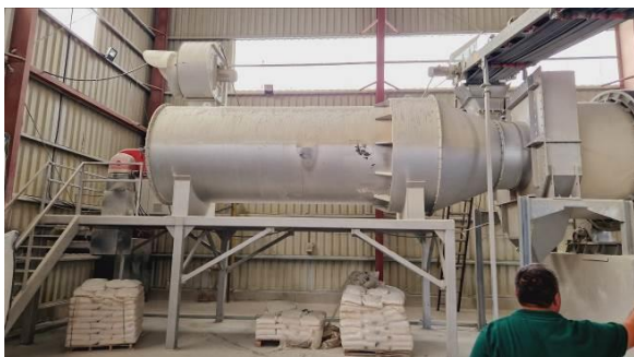
სურათი 2.3.2.4. ბუნებრივი აირის წვის სანთურა და საშრობი დოლი (ბუნებრივი აირის წვის ხარჯზე საშრობ დოლში შრება ნედლეული - ბენტონიტური თიხა)
