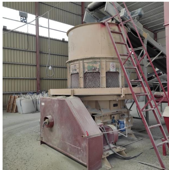
სურათი 2.3.2.2. ქვის სეპარატორი და შემრევი აგრეგატები
