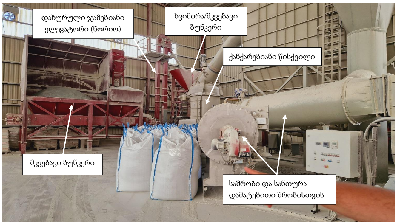
სურათი 2.3.3.2. საფქვავე ტექნოლოგიური დანადგარები
