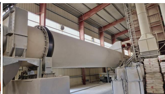
სურათი 2.3.2.4. ბუნებრივი აირის წვის სანთურა და საშრობი დოლი (ბუნებრივი აირის წვის ხარჯზე საშრობ დოლში შრება ნედლეული - ბენტონიტური თიხა)
