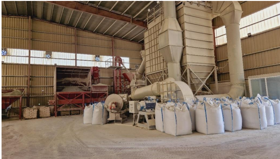
სურათი 2.3.3.1. დაფქვის ტექნოლოგიური ხაზი
