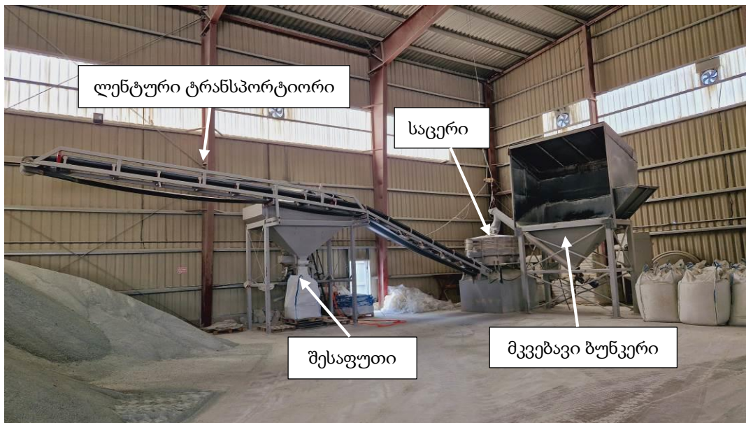
სურათი 2.3.4.1. გაცრის ტექნოლოგიური ხაზი (სადემონტაჟო არსებული ხაზი)
