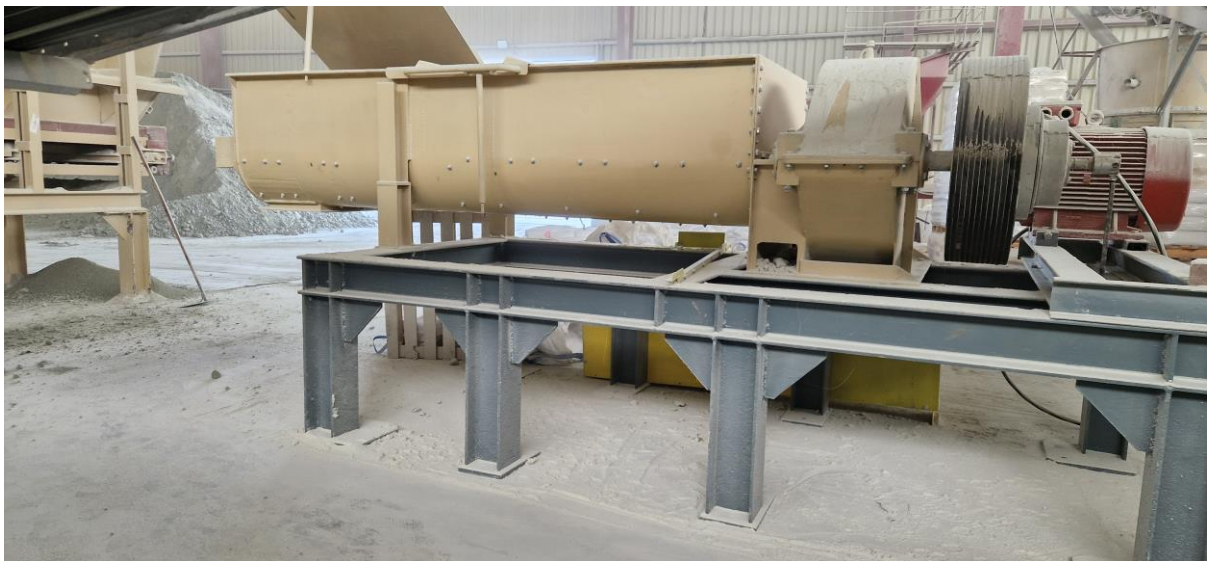
სურათი 3.1. დასამონტაჟებელი შემრევი, დროებით განთავსებულია საწარმოო შენობაში
