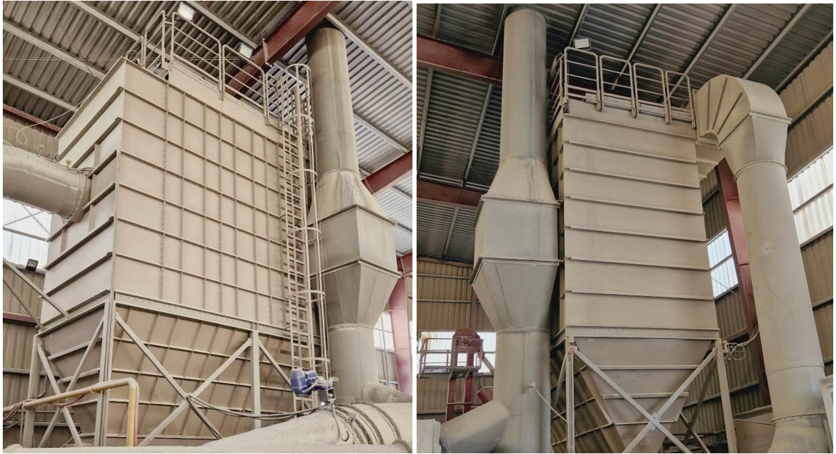
სურათი 2.3.3.3. დაფქვის ტექნოლოგიური ხაზის აირგამწმენდი სისტემა, სახელოვნიანი ფილტრები
