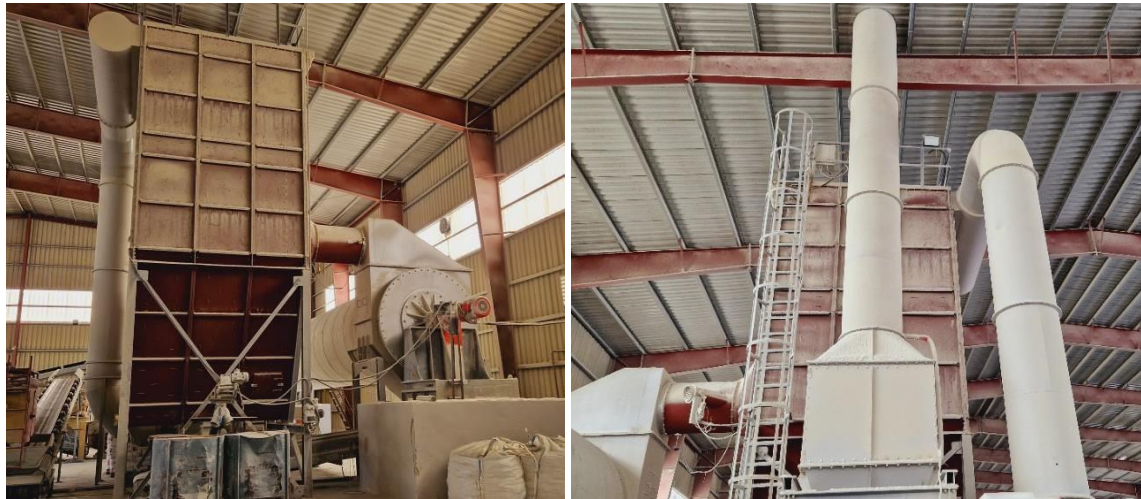
სურათი 2.3.2.6. საშრობი დოლის აირგამწმენდი სისტემა
